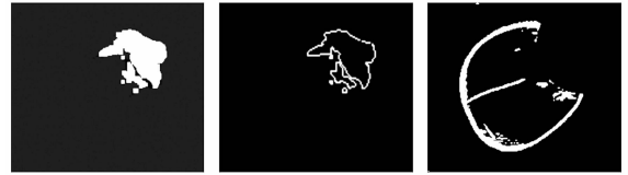
(a) 基于 B 通道分割并腐蚀、膨胀后的图像 (b) (a) 的轮廓 (c) 去除尖端部分后的种子边缘
