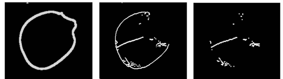
(a) 膨胀后的种子轮廓 (b) 图 5(c) 骨架化的图像 (c) (a)-(b) 的结果
